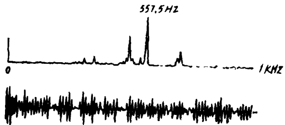
图9 左机启动时动力涡轮振动瞬时信号
