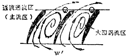
图4 逆流时设想的叶道内流动模式
