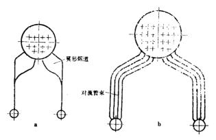
图 5 防止锅壳下部直接受火焰辐射的措施 a-1~4t/h. b-10t/h
