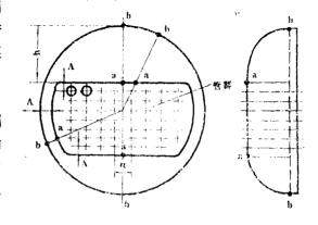
图 3 拱形管板结构示意图
