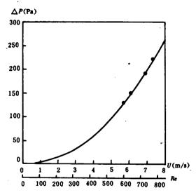
图 5 压降 △P 与流速 V 和雷诺数关系曲线
