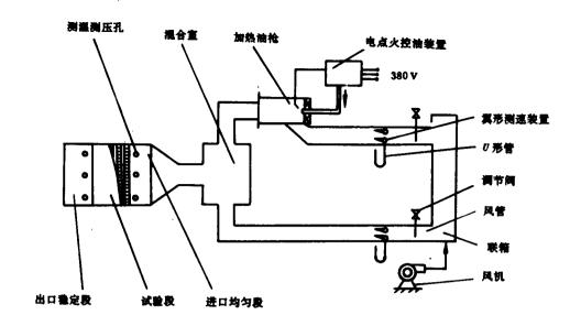
图 1 模拟换热器传热试验装置示意图
