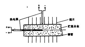
图 2 换热器热电偶布置图
