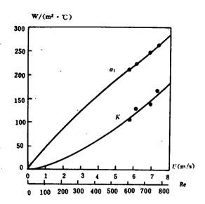
图 3 基于 Cu 管外表面积的空气侧换热系数 a 和总传热系数 K 与流速关系曲线
