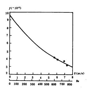
图 6 摩擦系数 ∫ 与流速 V 和雷诺 数关系曲线
