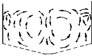
图 5 颗粒在床内的内循环运动
