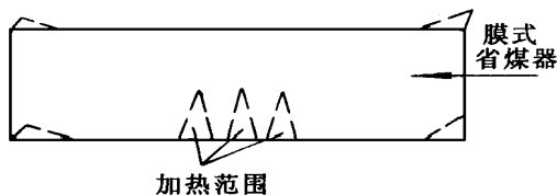
图 3 膜式省煤器管屏热校
