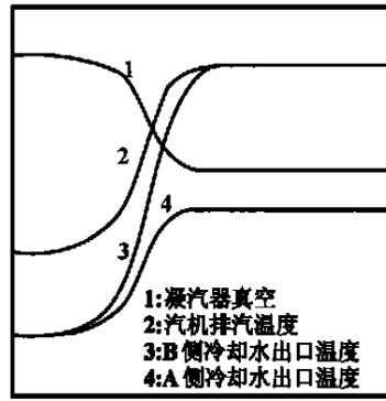
(a) 冷却水单侧停运后凝汽器参数变化
