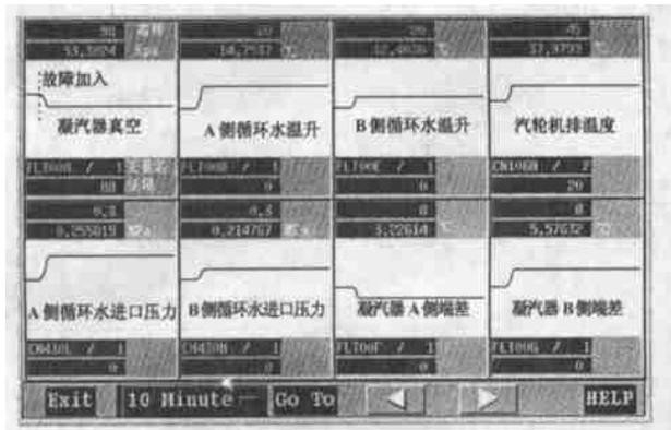
图 3 运用模型法提取“A 侧冷却管出口 闸门未全开或出口管道堵塞”故障样本知识
