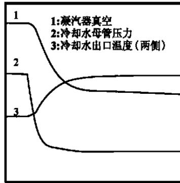
(b) 一台循环水泵停运后凝汽器参数变化
