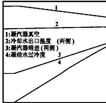
(c) 真空泵停运后凝汽器参数变化
