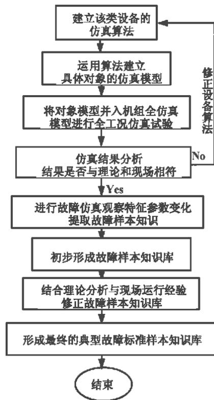
用仿真模型的方法实现故障样本知识提取的大致步骤如下(图1):
