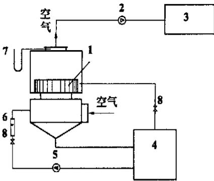
1—除水器; 2—风机; 3—整流罩; 4—水箱; 5—水泵;
