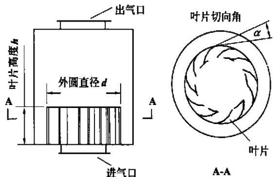
图1 除水器结构示意图
