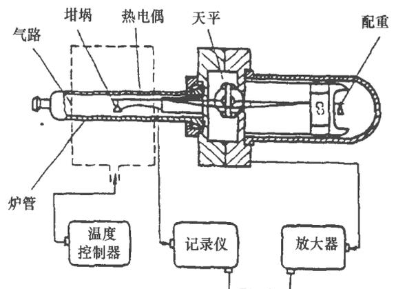
图 2 Du Pont 热天平简图
