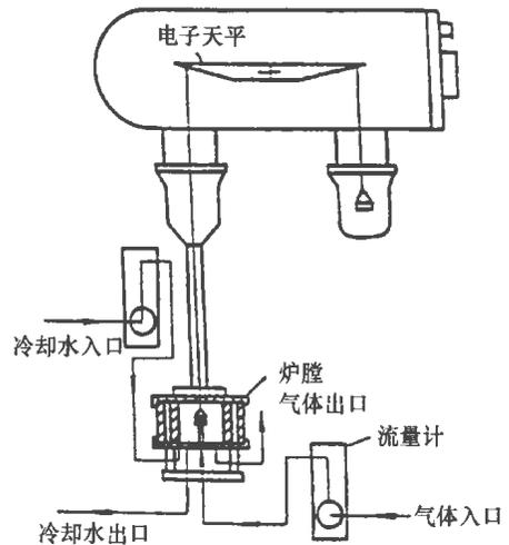
图 1 STA-780 型热天平简图
