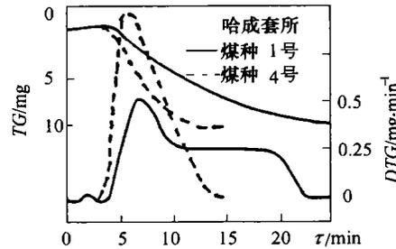
图 11 煤粉燃烧试验结果
