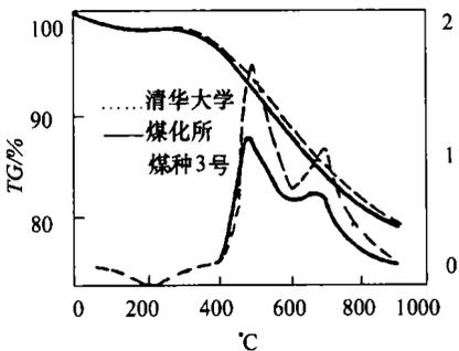
图 8 热解试验结果
