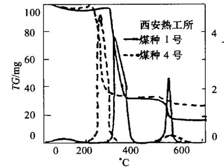
图 12 煤粉燃烧试验结果
