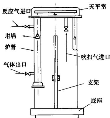
图 3 TGS-2 型热天平简图
