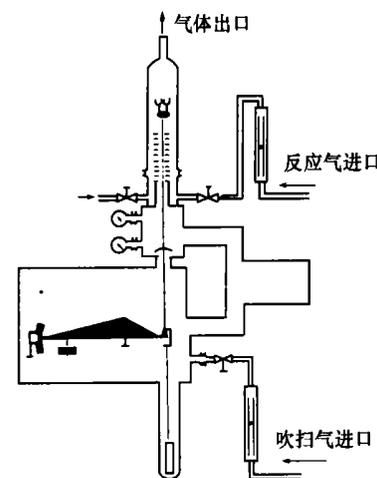
图 4 STA-429 型热天平简图
