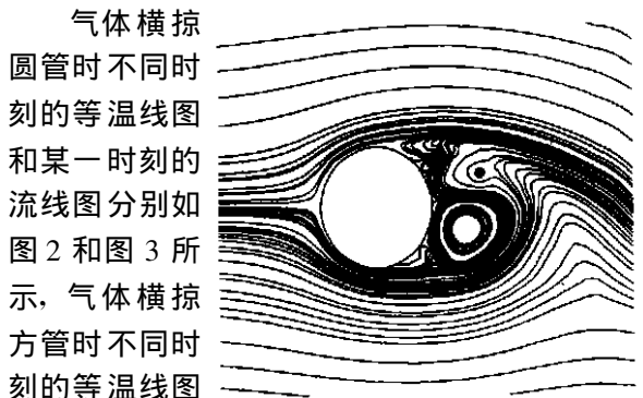
图 3 气体横掠圆管某一时刻的流线图
