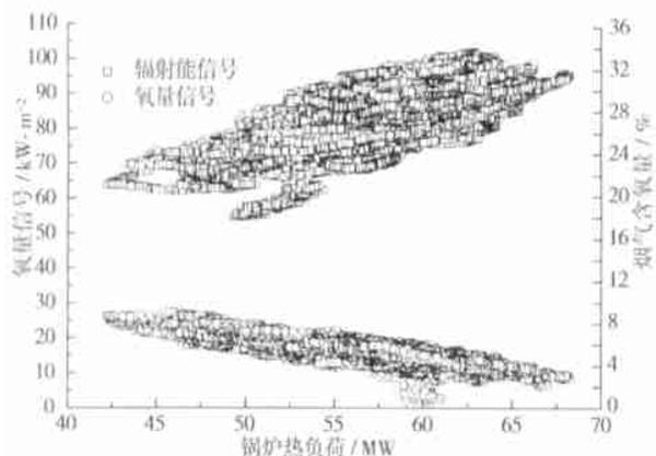
图 1 辐射能信号和氧量信号对比图
