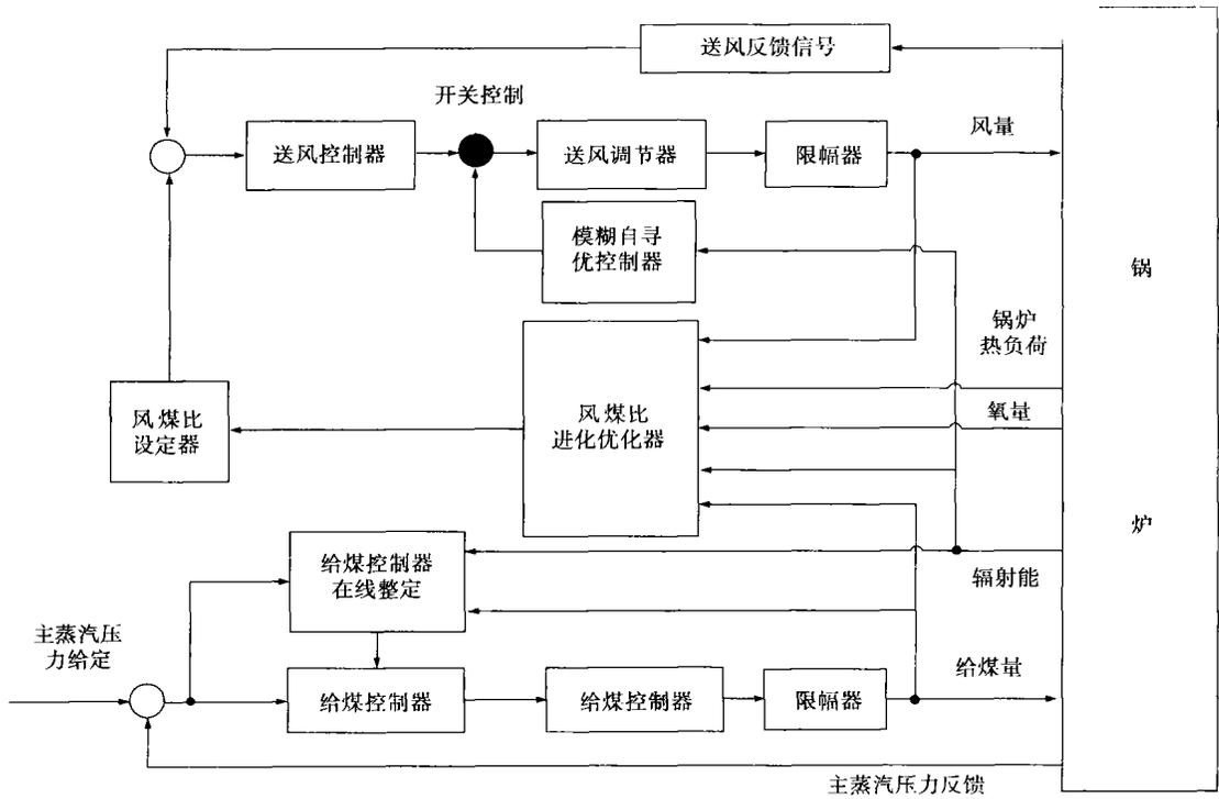
图 2 基于辐射能检测的燃烧进化优化系统
