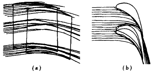
图 3 静叶栅中的固粒运动轨迹 ( d_p = 46 \mu\text{m} )
