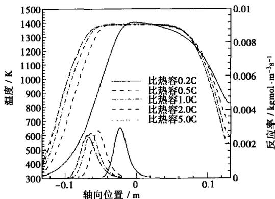
图 8 不同比热容时的温度分布及反应率比较
