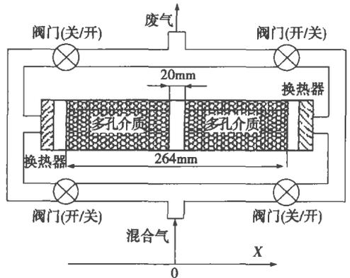
图 1 往复流动燃烧装置
