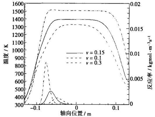
图 5 不同流速时温度场和反应率分布
