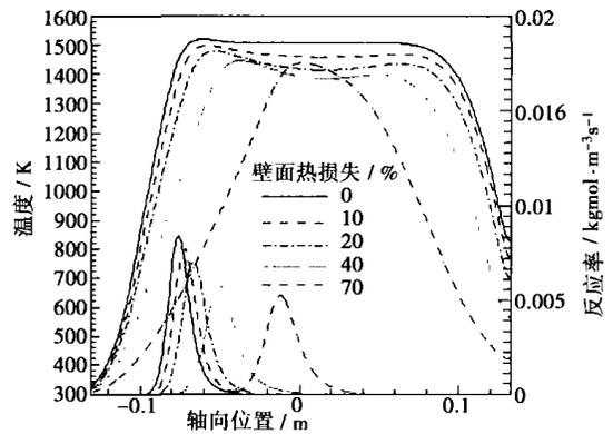
图 6 不同热损失时的温度分布及其反应率比较
