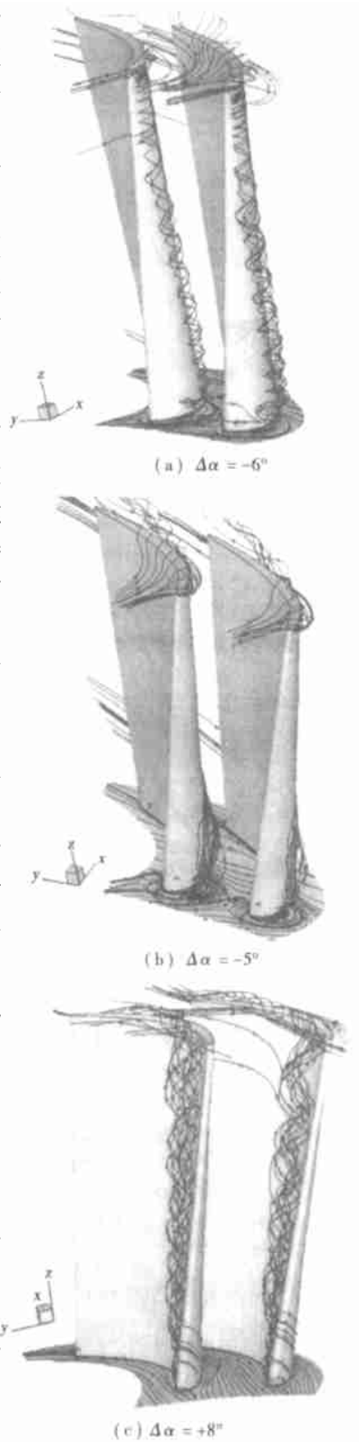
图 5 不同可调导转角下可调导叶级动叶片流道内的空间三维分离涡流场结构
