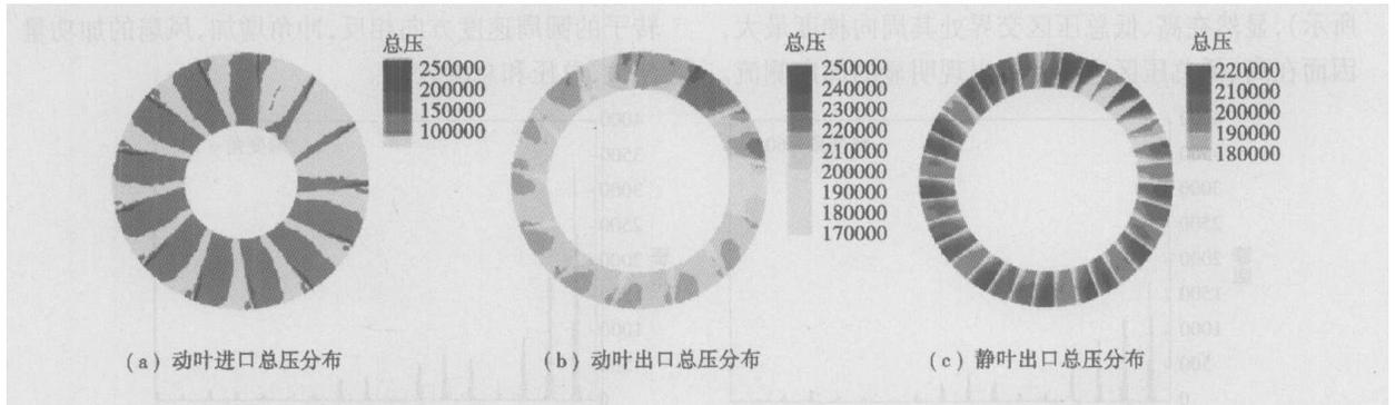
图 4 风扇进出口总压分布( $\theta_D=60^\circ$ )
