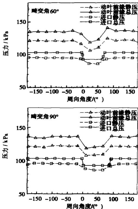
图 3 风扇进口及动叶前缘处总压和静压分布
