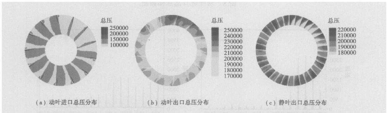
图 5 风扇进出口总压分布( $\theta_D=90^\circ$ )
