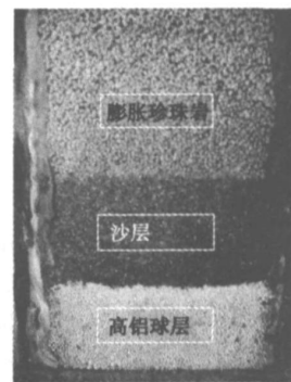
图 1 双层滤料过滤床的 3 层结构
