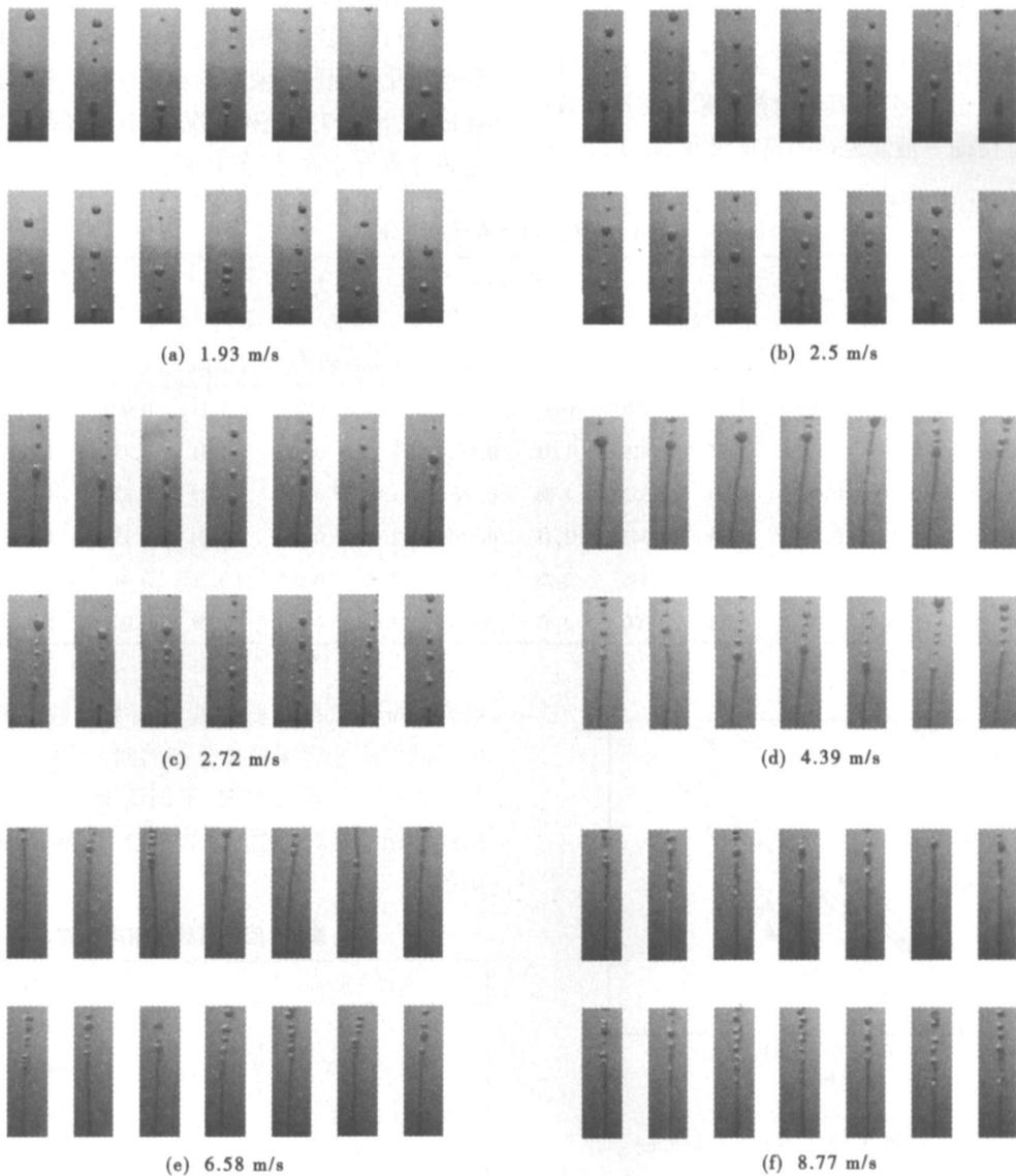
图4 射流长度波动的峰点与谷点对应的雾化照片
