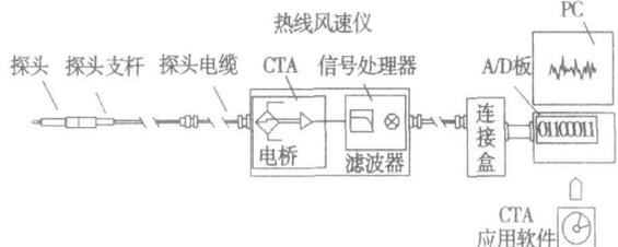
图 6 热线测量系统框图
