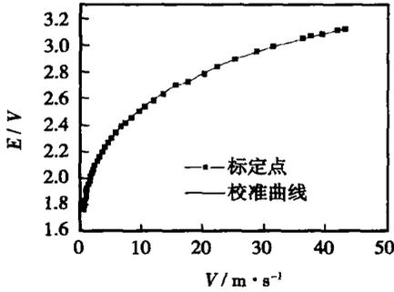
图 8 单斜丝热线速度校准曲线
