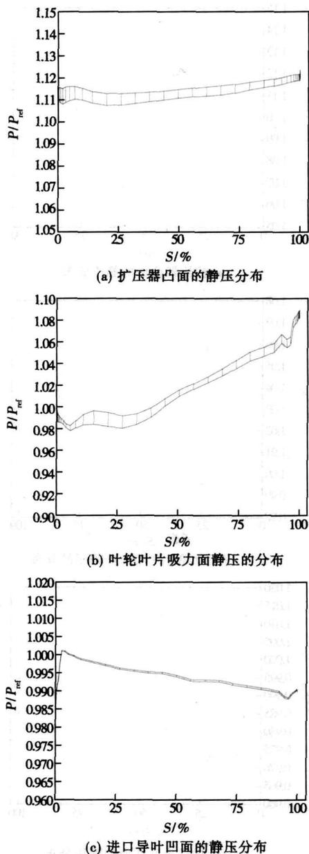
图 7 质量流量为 3.2 kg/s 时进口导叶负预旋 30° 下 3 部件相干时叶片上的静压分布
