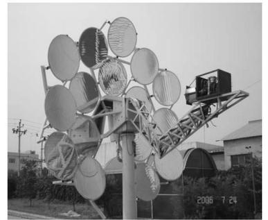
图 9 中科院电工所研制的碟式太阳能热发电装置
