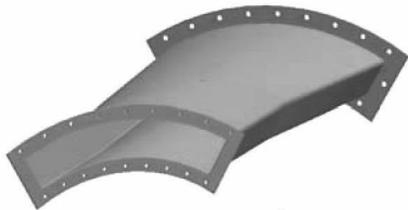
图 3 变冲角段模型
