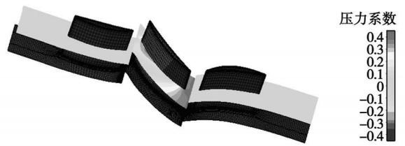
图 7 50%叶高截面压力系数分布云图
