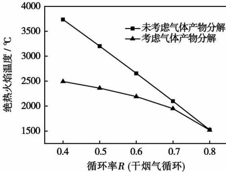
图 2 考虑气体产物分解前后绝热火焰温度的比较
