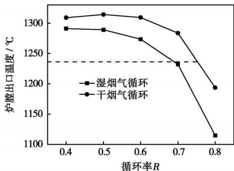
图 5 不同循环率下炉膛出口温度的计算结果
