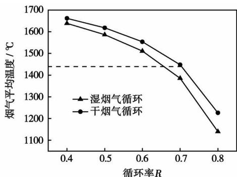
图 6 不同循环率下烟气平均温度的计算结果
