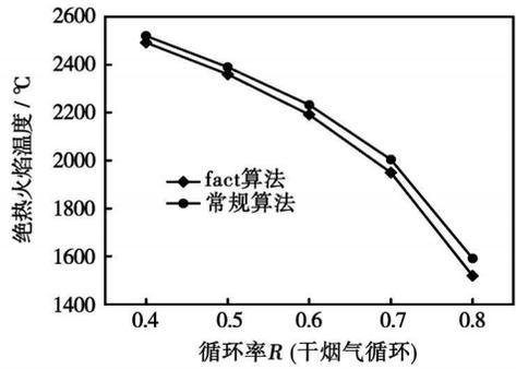
图 3 不同计算方法的绝热火焰温度的对比
