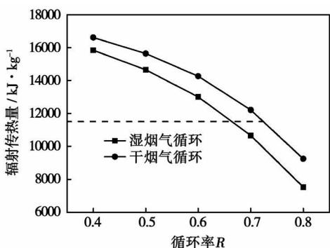
图 7 不同循环率下炉膛辐射传热量的计算结果
