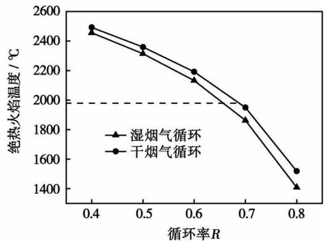
图 4 不同循环率下的绝热火焰温度计算结果
