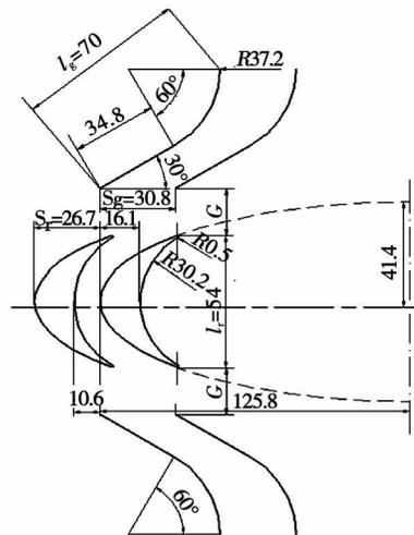
图 1 配有导流叶片冲击式透平的设计尺寸(mm)
