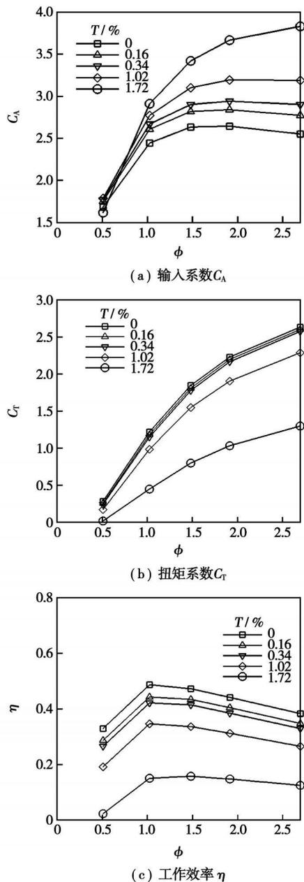
图 7 不同外径间隙下透平的工作性能
