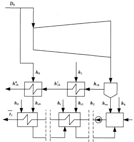
图 1 二回路高压加热器及再热系统
