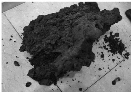
图1 印尼煤与越南煤混合燃烧时的大渣
