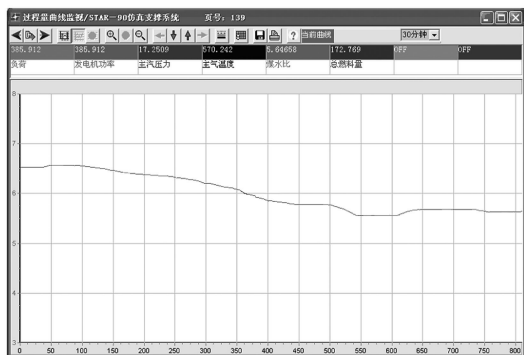
图 5 ADRC 控制器降负荷时的煤水比曲线
