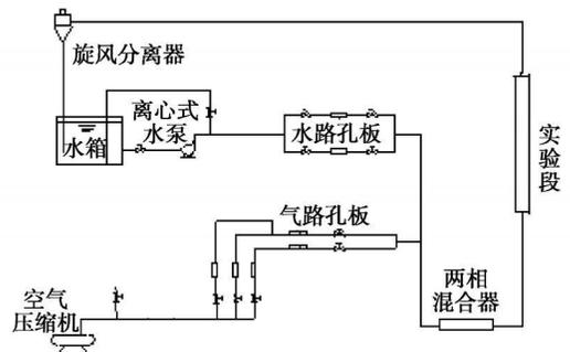
图 1 空气—水两相实验系统图
