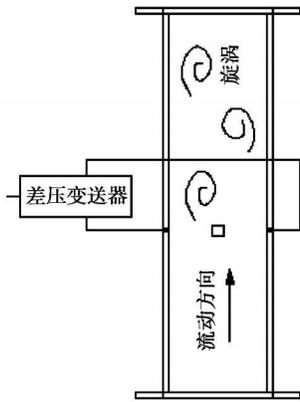
图 2 压差法测量旋涡脱落频率
