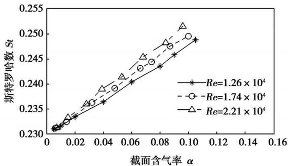
图 7 圆柱体斯特罗哈数与截面含气率的关系
