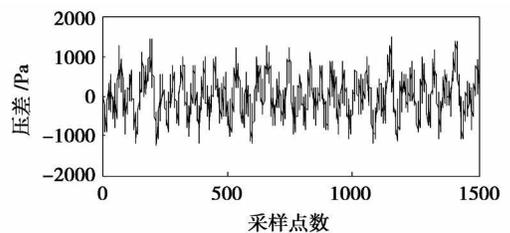
图 3 圆柱体管壁压差信号
