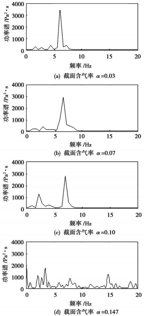
图 6  $Re=1.74 \times 10^4$  时各含气率下方柱体的管壁压差功率谱
