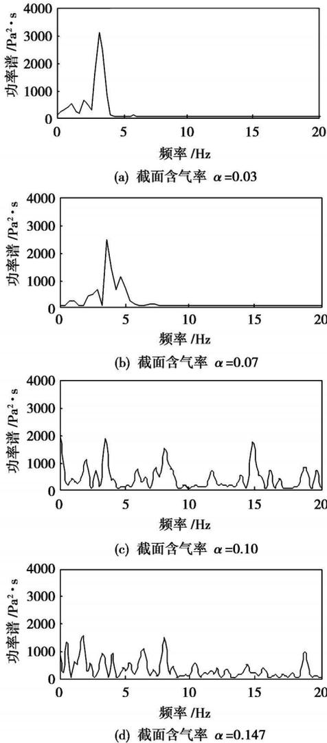
图 5  $Re=1.74 \times 10^4$  时各含气率下圆柱体的管壁压差功率谱
