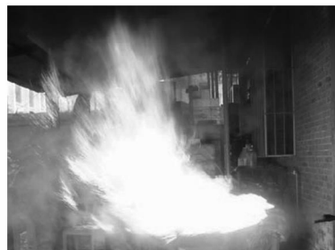
图 8 采用机械搅拌装置进行煤焦油乳化燃烧时的火焰情况
