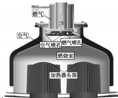
图 1 某热气机燃烧系统示意图
