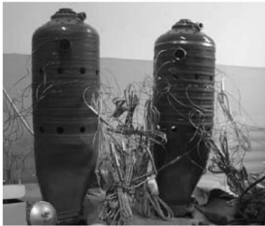
图 6 敷设有热电偶的火焰筒
