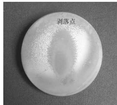
图 3 300 °C 试件试验后的表面照片
