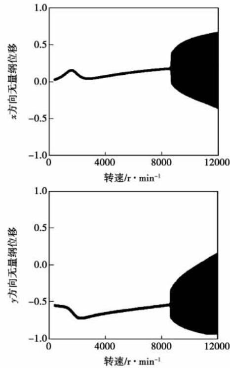
图 2 单盘转子-密封系统分岔图
