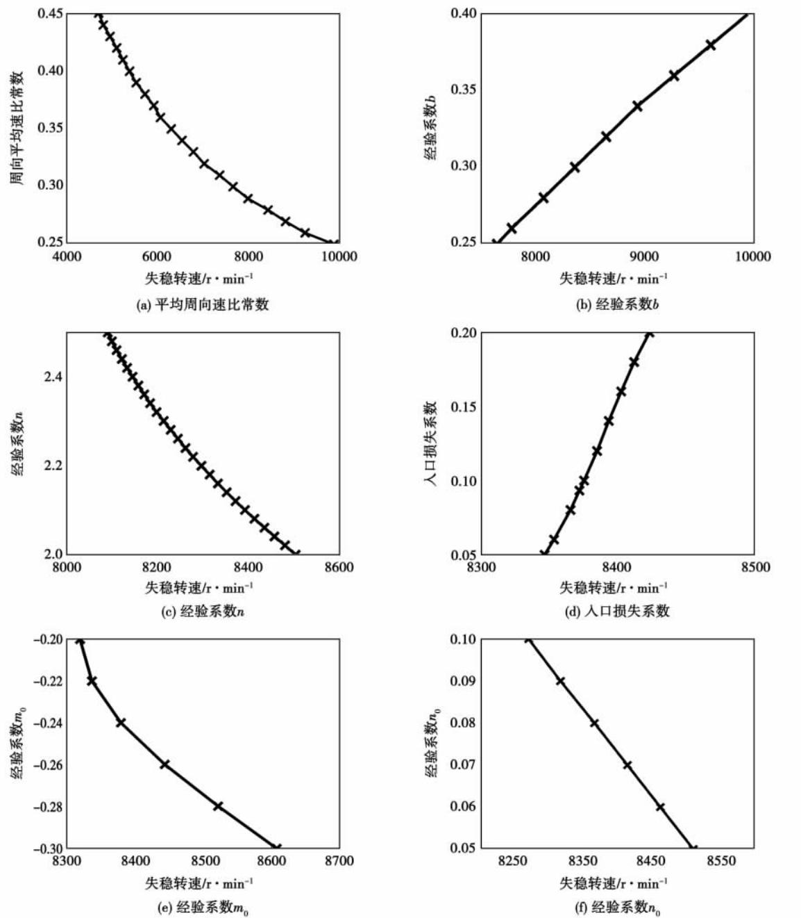
图 4 经验系数对单盘转子-密封系统稳定性的影响规律
