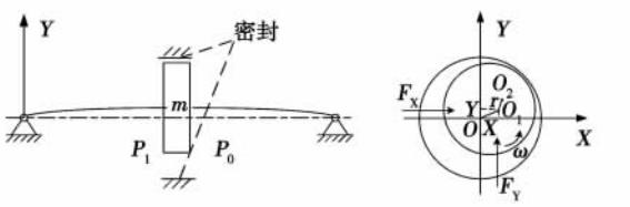
图 1 单盘-转子密封系统动力学模型
