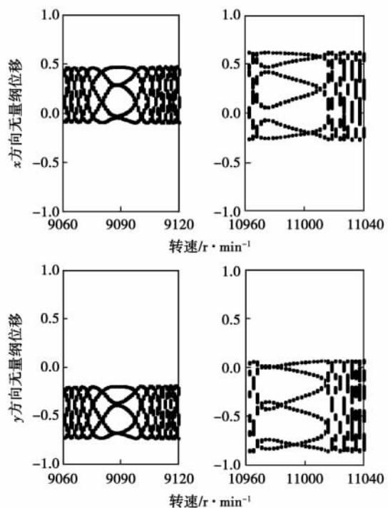
图 3 单盘转子-密封系统分岔图局部放大图
