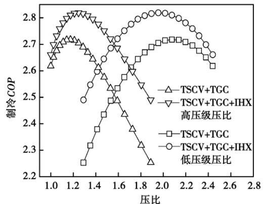
图 6 COP 随循环压比的变化
