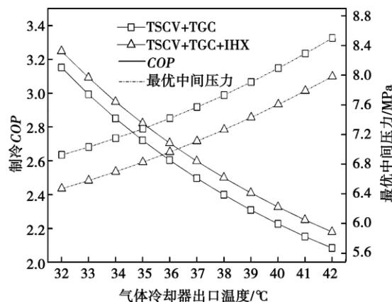
图 8 双级 COP 和中间压力随冷却温度的变化
