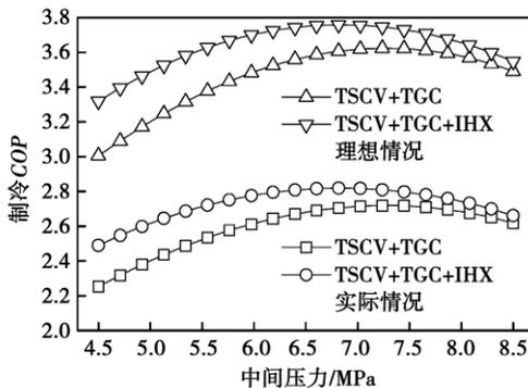
图 4 COP 随中间压力的变化
