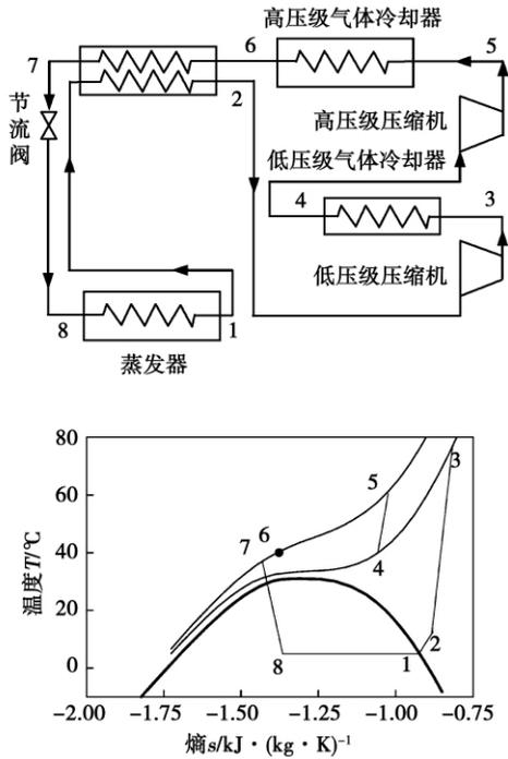
图 2 CO<sub>2</sub> 跨临界双级压缩带回热器循环 TSCV + TGC + IHX 原理图和 T - s 图
