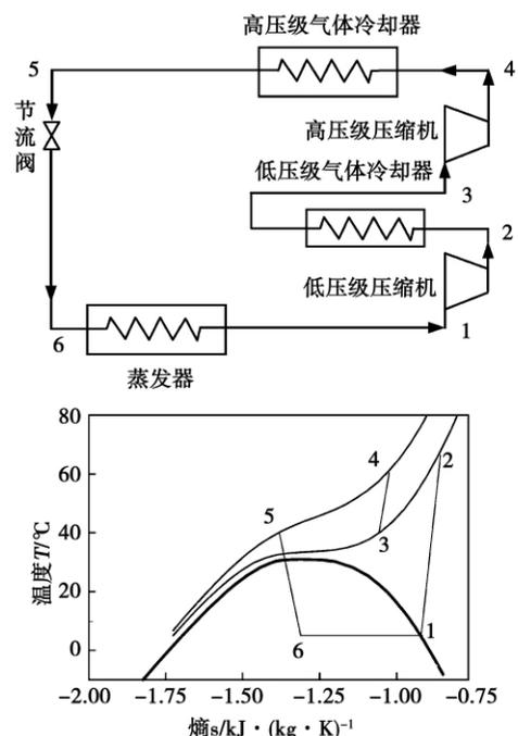
图 1 CO<sub>2</sub> 跨临界双级循环 TSCV + TGC 原理图和 T-s 图
