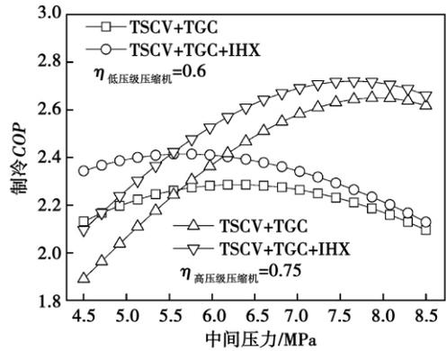
图 5 COP 随中间压力和压缩机效率的变化
