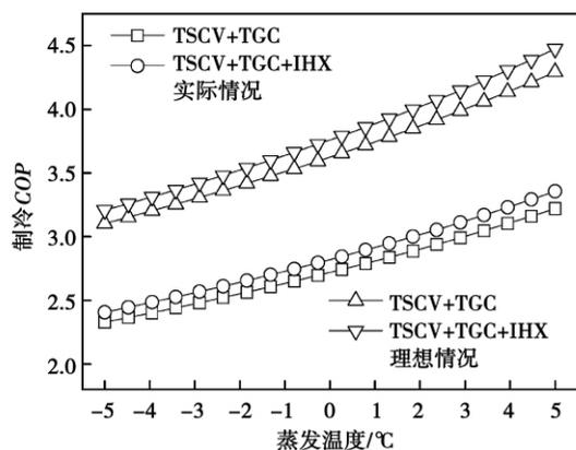
图 7 双级循环 COP 随蒸发温度变化
