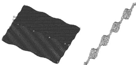
图 8 波纹板通道的网格划分
