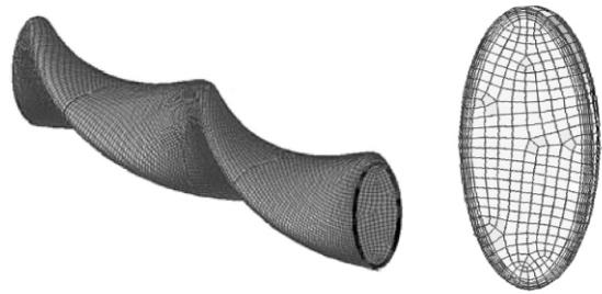
图 2 螺旋扭曲扁管的网格划分
