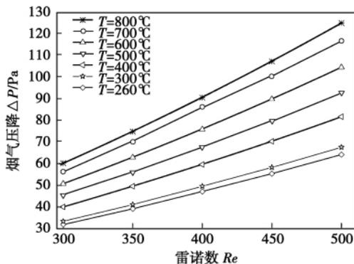
图 9 烟气侧压降随雷诺数变化
