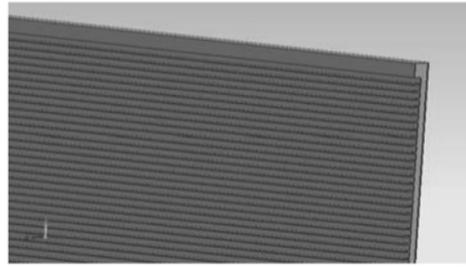
图 3 钎焊前的铝基微通道局部模型
