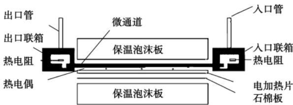
图 2 换热段示意图
