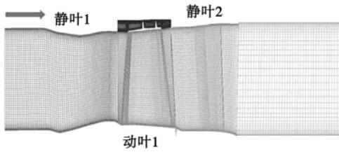
图1 某1.5级涡轮的计算域
