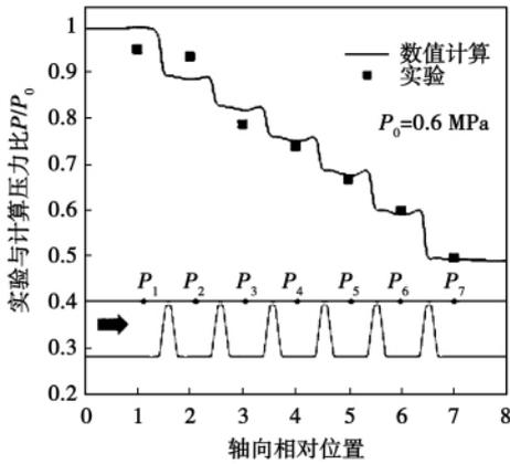
图 5 篦齿盘齿间相对静压的实验与数值计算对比
