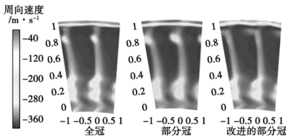
图 16 动叶出口相对周向速度
