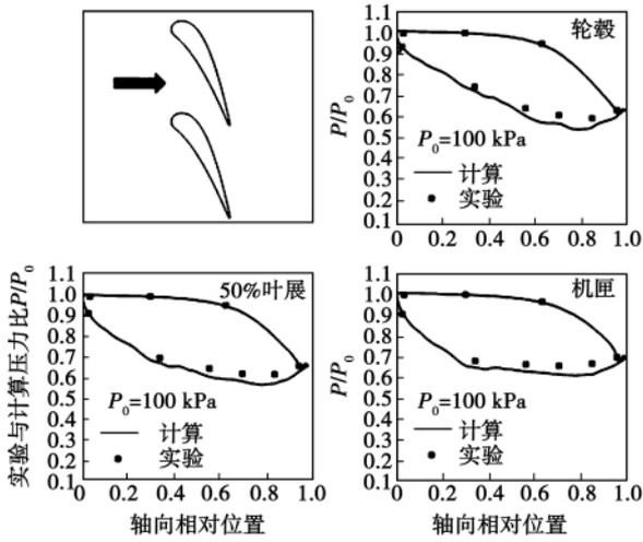
图 4 环形叶栅不同叶展的压力面和吸力面相对静压的实验与数值计算对比
