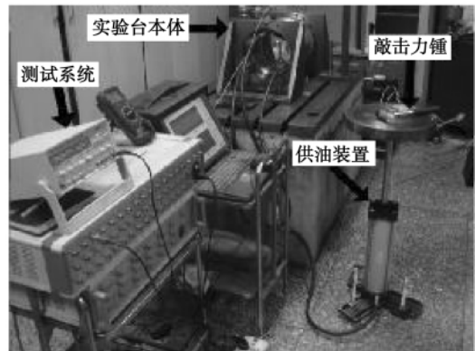
图 3 挤压油膜阻尼器动力学测试试验台
