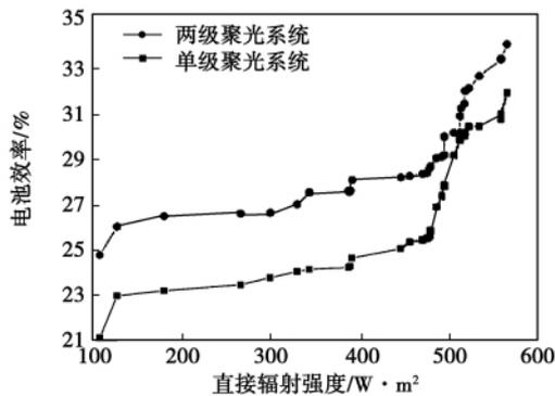
图 8 直射辐射强度对电池转换效率的影响
