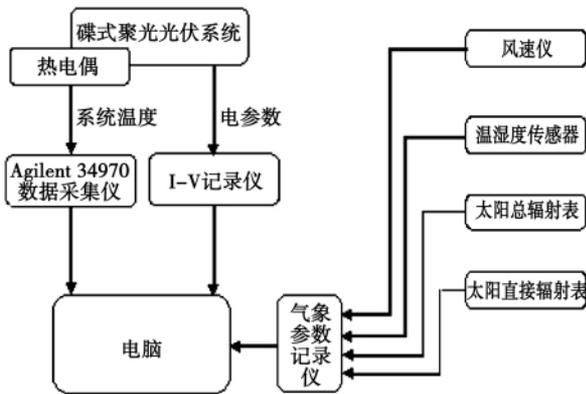
图 3 碟式聚光光伏系统性能测试系统
