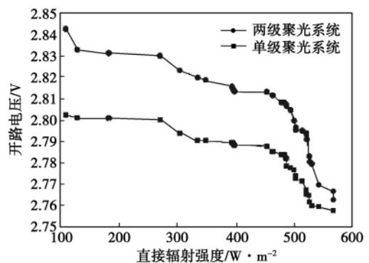
图 5 直射辐照强度对电池开路电压的影响
