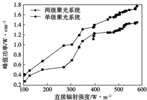
图 7 直射辐射强度对电池峰值功率的影响
