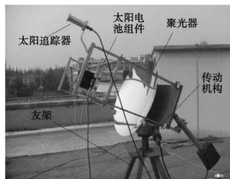
图 1 太阳能碟式聚光光伏系统
