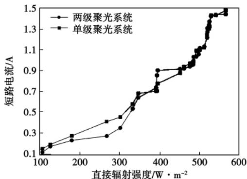
图 6 直射辐照强度对电池短路电流的影响
