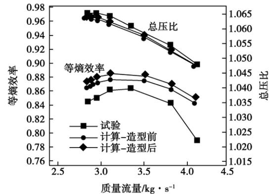
图 2 压气机特性图
