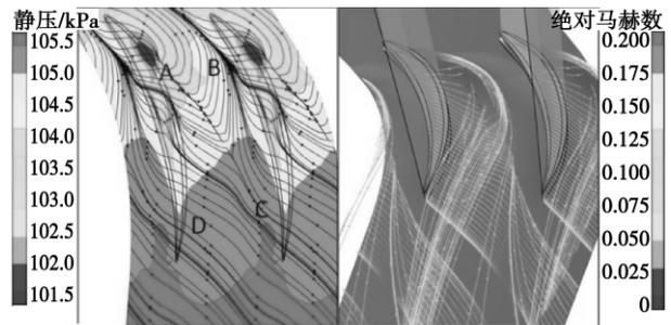
图 8 静子壁面静压分布、极限流线及间隙流线图
