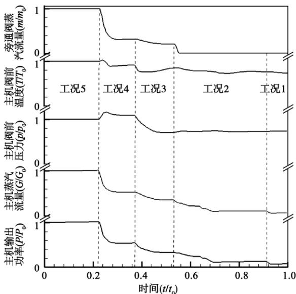
图 5 减速过程中参数动态变化曲线
