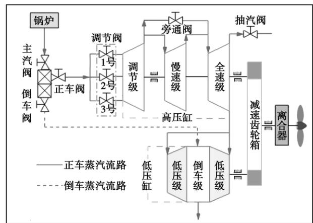
图 1 主汽轮机系统简图
