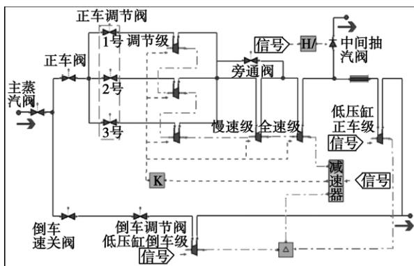
图 3 主汽轮机仿真模型
