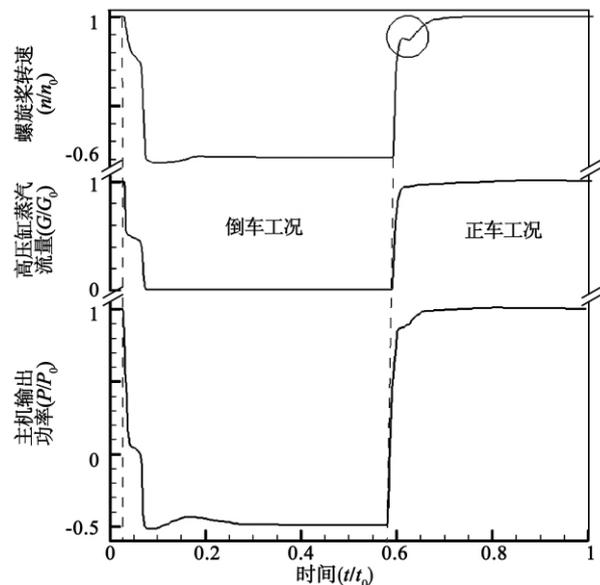
图 6 倒车过程中参数动态变化曲线
