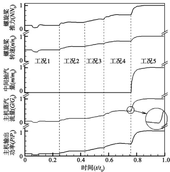
图 4 加速过程中参数动态变化曲线
