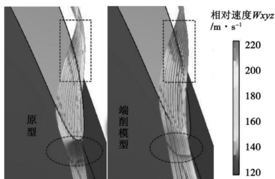
(b) 叶顶前缘泄漏溜流线
