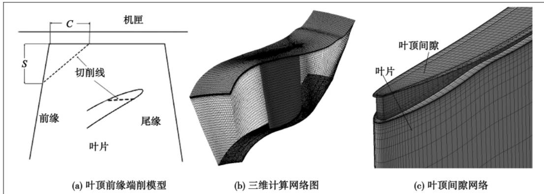
图 1 端削模型及计算网格
