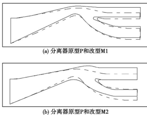
图 7 分离器原型和改型的型线
