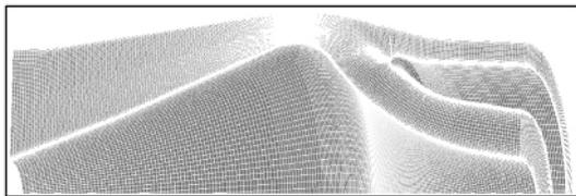
图 2 分离器流道网格示意图
