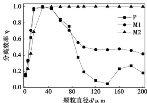
图 8 分离器原型和改型的分离效率的比较
