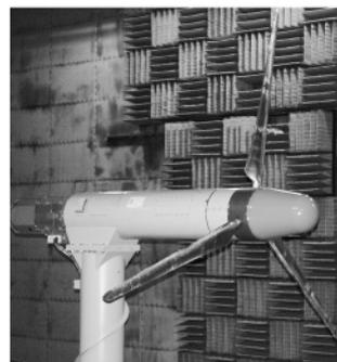
图5 风轮实验模型
