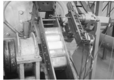
图 3 亚音速平面叶栅风洞照片
