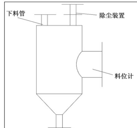
图 3 快速分离器结构图
