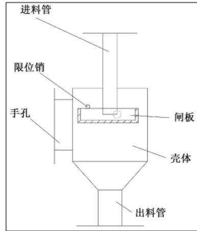
图 2 高温固体料阀结构图
