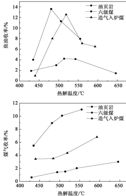
图 4 3 种煤热解时焦油收率及煤气收率随热解温度的变化规律
