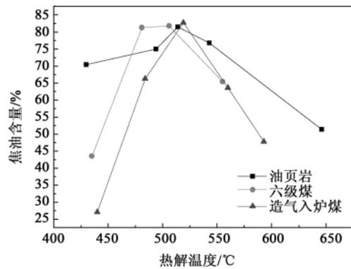
图 8 液体产物中煤焦油含量随热解温度的变化规律
