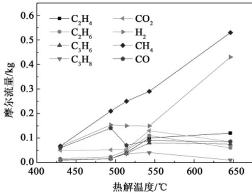
图 5 油页岩热解时煤气中各组分摩尔流量随热解温度的变化规律
