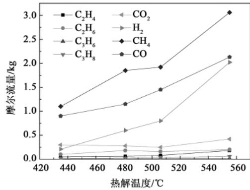
图 7 六级煤热解时煤气中各组分摩尔流量随热解温度的变化规律
