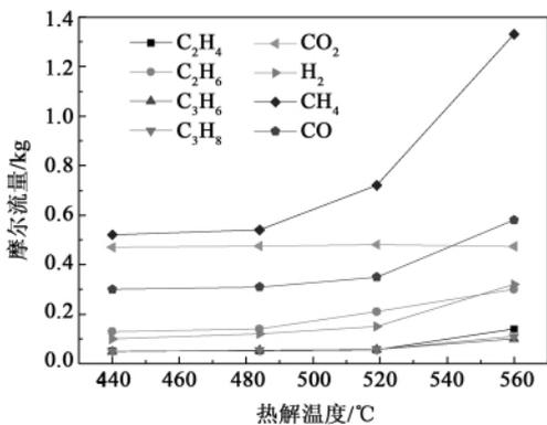
图 6 造气入炉煤热解时煤气中各组分摩尔流量随热解温度的变化规律
