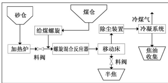
图 1 煤拔头小试实验台装置流程图
