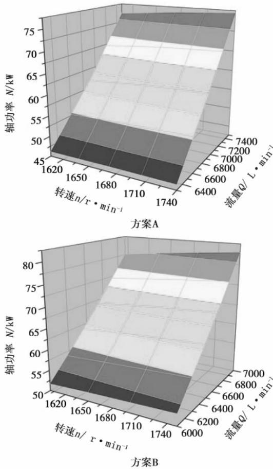
图 4 流量 - 功率 - 转速关系图
