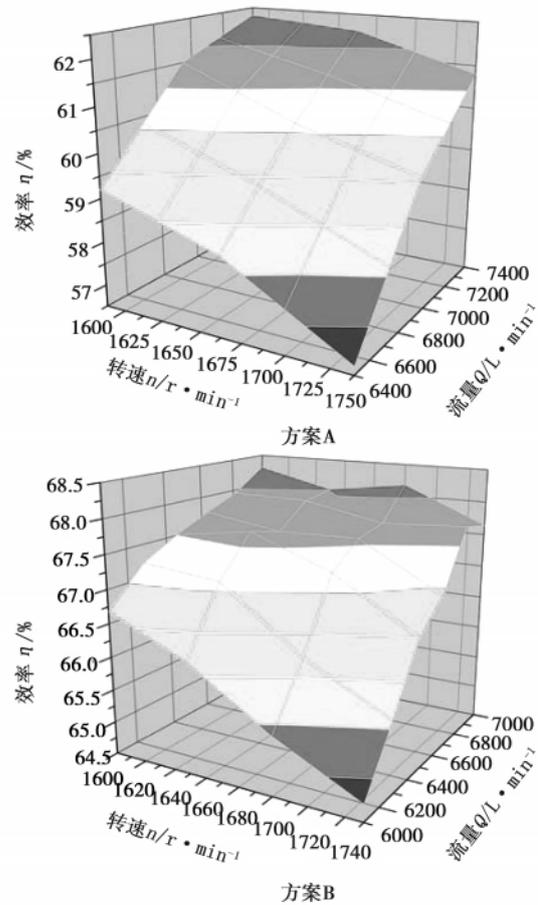
图 5 流量 - 效率 - 转速关系图
