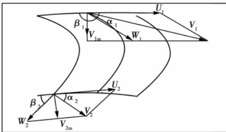
图 2 叶片进出口速度三角形
