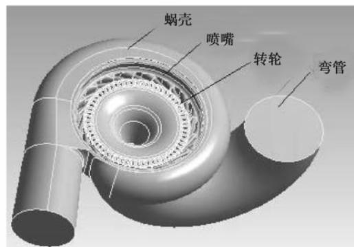
图 3 油涡轮全流道三维模型
