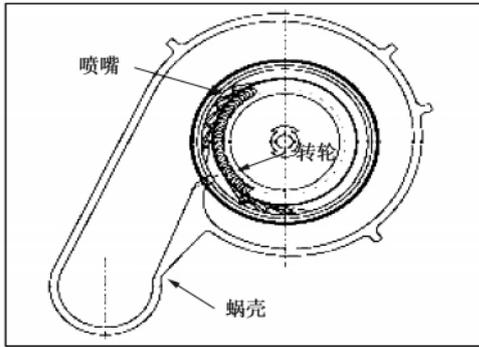
图 1 油涡轮的基本结构
