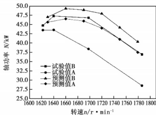
图6 油涡轮转速-功率对比曲线
