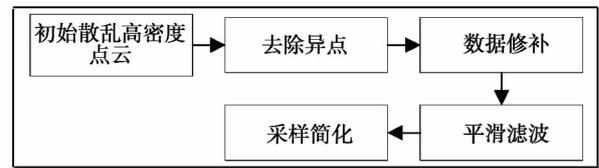
图 4 散乱高密度点云预处理流程
