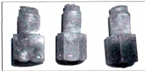
图 16 涂抹 7451 断裂的螺钉及断口 ( II号断裂位置)
