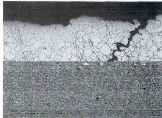
图 9 螺钉纵剖面的沿晶裂纹
